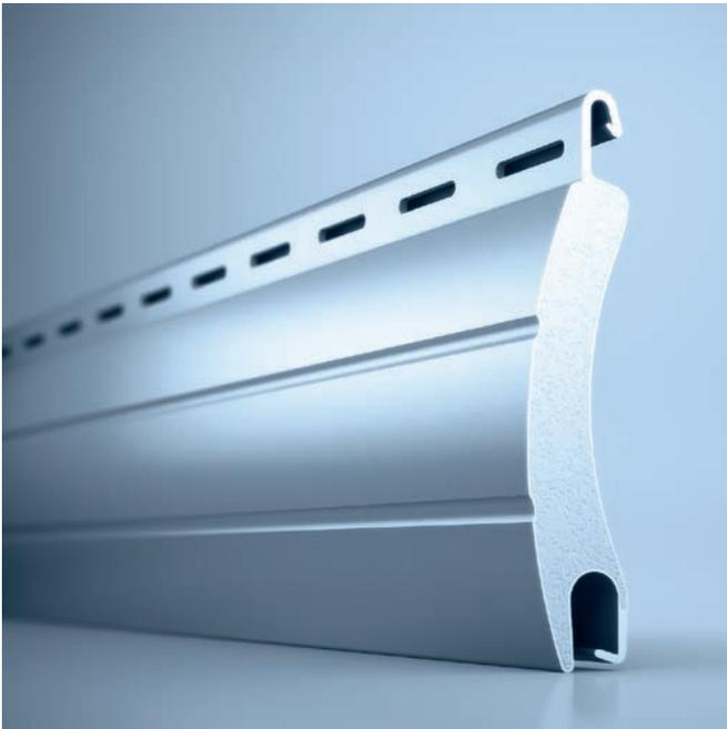
Der heroal RS 42 bietet bei einem Gewicht von 3,9 kg / m<sup>2</sup> eine platzsparende und enge Wicklung. Bei einer Elementbreite von 2.900 mm erreicht er die sehr guten Werte der Windlastwiderstandsklasse 3 durch eine robuste Wandstärke von 9,3 mm.
