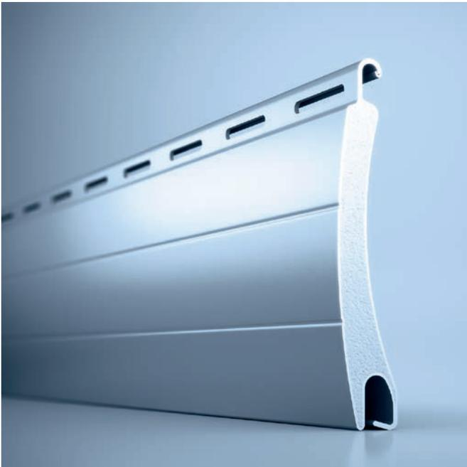
Die sehr enge Wicklung und der geringe Ballendurchmesser (Ø 160 mm bei einer Panzerhöhe von 2.500 mm) sind die Vorteile des heroal RS 37. Erreicht wird dies durch den Einsatz des filigransten Stabes im heroal Sortiment (nur 8 mm Nennstärke) – eine perfekte Lösung bei baulichen Anforderungen an sehr kleine Kastengrößen.
