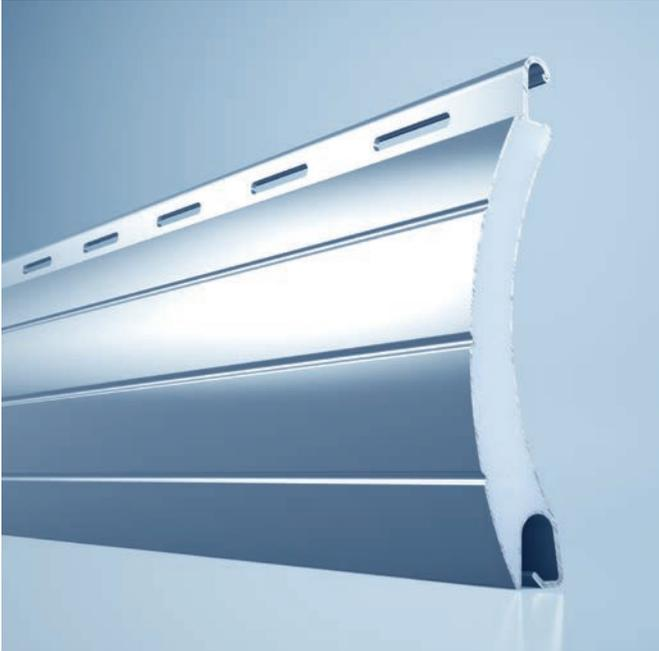
Die Stabilität der Rollladenstäbe der 50er-Serie zeichnet auch den heroal RS 52 aus. Mit einer Nenndicke von 13,5 mm und der mitteldichten Ausschäumung erfüllt der Stab exzellente Windlastwerte – Windlastwiderstandsklasse 4 für Elementbreiten bis 3.200 mm. Er ist bestens für den Einsatz in kleinen Rollladenkästen geeignet (Ø 198 mm Ballendurchmesser ergeben sich bei einer Panzerhöhe von 2.500 mm).
