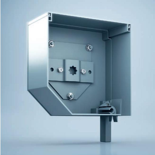
Sehr hohen Schutz gegen Einbruchversuche bietet das stranggepresste Blendensystem heroal FMS 45°, mit dem die Anforderungen an Sicherheitsrollläden der Widerstandsklassen RC 2 und RC 3 der DIN EN 1627 erfüllt werden. Dafür sorgen u. a. Wandungen mit über 3 mm Stärke, eine besondere Sicherheitsverhakung, die nur mit einem Spezialschlüssel zu öffnen ist und Blendkappen aus widerstandsfähigem Stahl.
