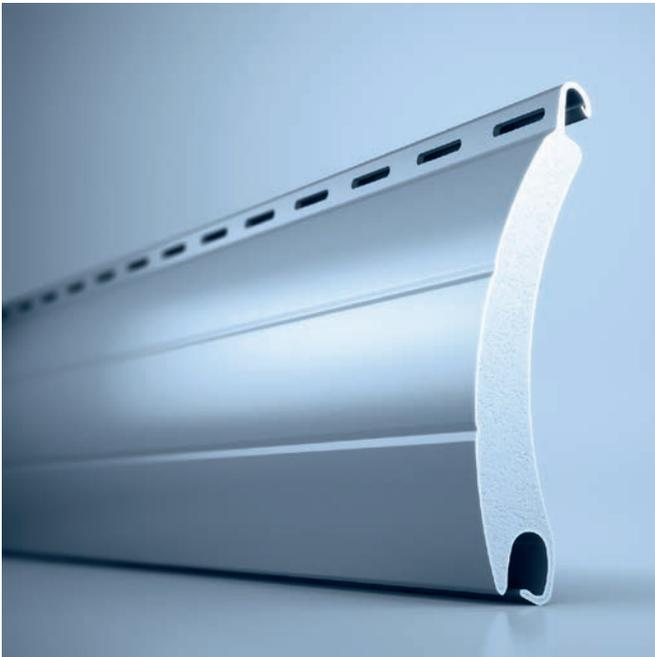
Das hervorragende Wickelverhalten der 50er-Serie zeichnet auch den heroal RS 54 aus. Die optimale Stabgeometrie sorgt für den geringen Ballendurchmesser (Ø 205 mm Ballendurchmesser bei einer Panzerhöhe von 2.500 mm). Damit lässt sich der Stab auch in herkömmlichen Vorbau-Rollladensystemen mit kleinsten Kastengrößen verbauen.
