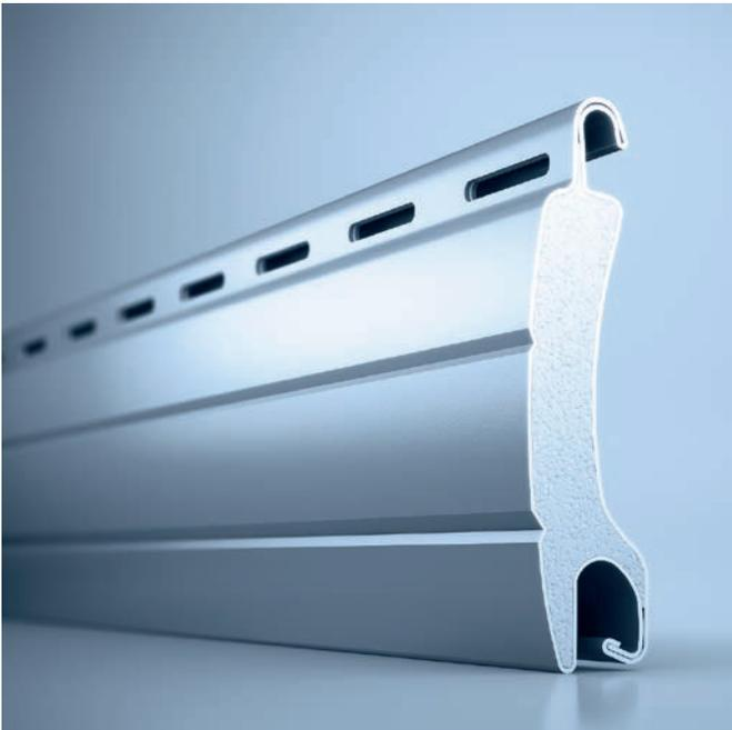
Die geringe Deckbreite von 32 mm macht den heroal RS 32 – den kleinsten Rollladenstab im heroal Sortiment – so stark. Denn dank der kompakten Ausführung erfüllt er bei einer Elementbreite von 2.700 mm die Anforderungen der Windlastwiderstandsklasse 3.
