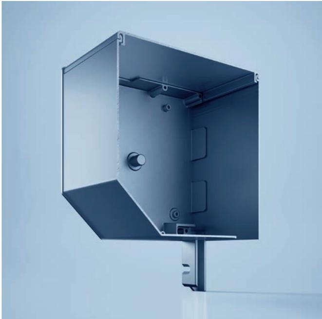
Eine stabile und sichere Kastenlösung bietet das stranggepresste Blendensystem heroal FME 45°. Es erfüllt die Anforderungen der BVRs-Richtlinie TR 111 zur erhöhten Einbruchhemmung und ist auch bei großen Elementbreiten absolut formstabil. Die 45°-Schräge sorgt für mehr Lichteinfall.
