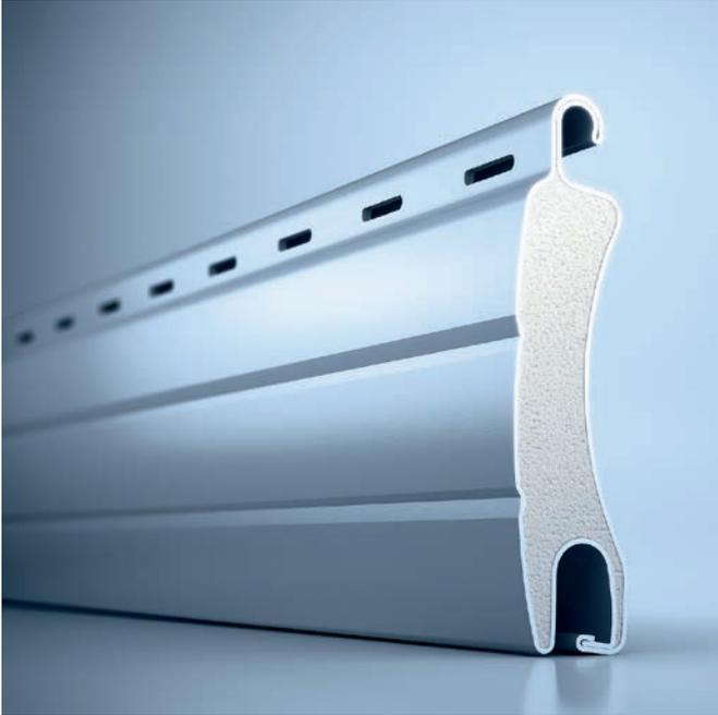
Die außergewöhnliche Materialstärke und mitteldichter Schaum machen den heroal RS 37 SL zu einem konkurrenzlos hochstabilen Rollladenstab. Er erfüllt die Anforderungen der Windlastwiderstandsklasse 4 bei Elementbreiten bis 3.000 mm sowie die BVRS-Richtlinie TR 111 im Bereich der Einbruchhemmung.
