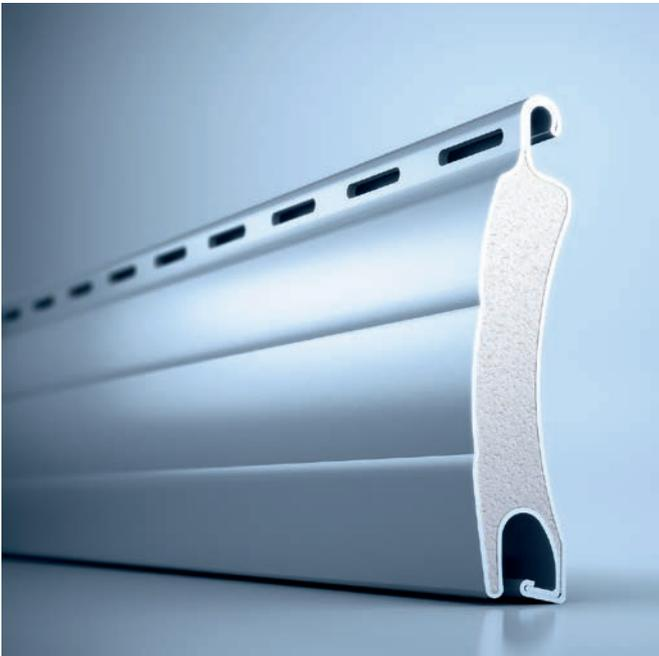
Der hochdichte Schaum verleiht dem filigranen Stab heroal RS 37 RC 2 bei einem Gewicht von 8,0 kg / m<sup>2</sup> seine extreme Biegefestigkeit und Stabilität. Mit einer Deckbreite von 37 mm und einer Nenndicke von 9,5 mm ist der Stab bis zur Widerstandsklasse RC 2 nach DIN 1627 geprüft und zugelassen. Zusätzlich wurde der heroal RS 37 RC 2 mit der Hagelschlagklasse 7 ausgezeichnet.
