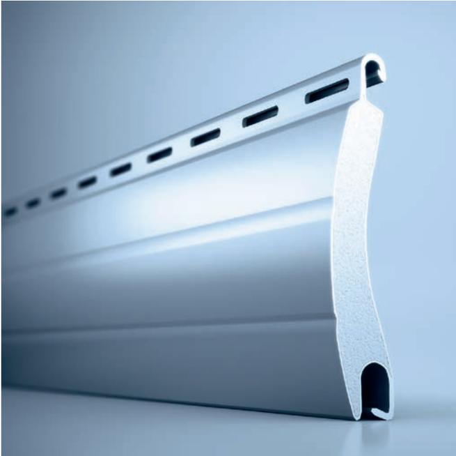
Der heroal RS 41 wickelt mit einer großen Deckbreite (41 mm) und schmalen Nenndicke (8,5 mm) sehr eng und ist bestens für den Einsatz in kleinen Rollladenkästen geeignet (Ø 185 mm Ballendurchmesser bei einer Panzerhöhe von 2.500 mm). Der sehr stabile Rollladenstab mit geringem Gewicht (3,7 kg / m<sup>2</sup>) erfüllt Windlastwerte der Widerstandsklasse 3 bei Elementbreiten bis 2.900 mm.
