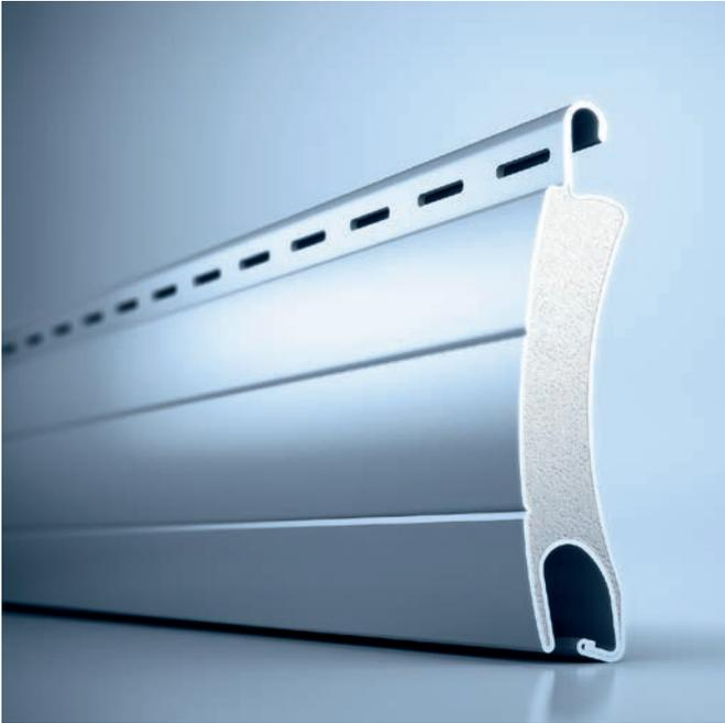
Die extrem biegefesten Standard Safe-Stäbe mit einer Nenndicke von 14 mm und einem hochdichten Schaum sind für den Bau von Sicherheitsrollläden gemäß DIN 1627 bis zu der Widerstandsklasse RC 2 ausgelegt. Der heroal RS 53 RC 2 erreicht ausgezeichnete Windlastwerte bis Widerstandsklasse 6 bei Elementbreiten bis 3.200 mm. Zusätzlich wurde der heroal RS 53 RC 2 mit der Hagelschlagklasse 7 ausgezeichnet.
